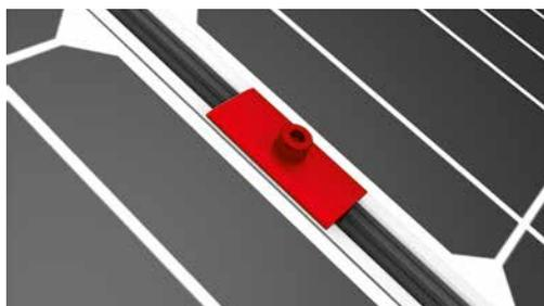
Alternativ: Zwischen zwei Modulen jeweils zwei XS Mittelklemmensets verwenden. Anzugsdrehmoment: 14 Nm
