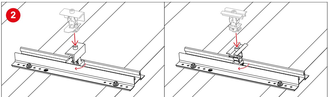
! Die Schraubenachse der Klemme muss innerhalb der Schraubenachsen der Bohrschrauben liegen.
