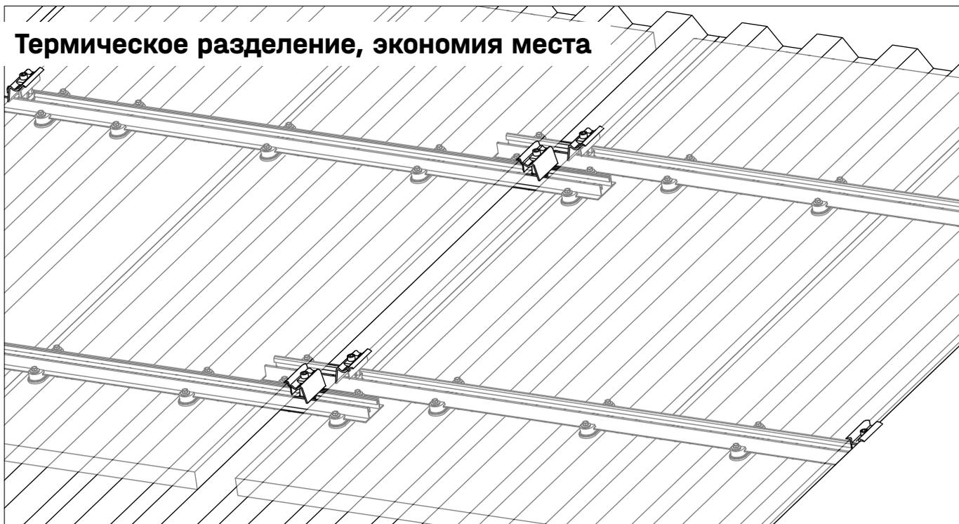
**Монтаж с горизонтальной ориентацией и с помощью поперечного профиля**
