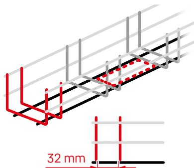
Bei schmalen Gitterrinnen mit **einem Auflagedraht**, mittig im PVX Minimount® platzieren und über den **quer verlaufenden Gitterdraht** fixieren.
