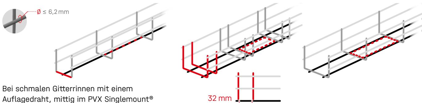
Bei schmalen Gitterrinnen mit einem Auflagedraht, mittig im PVX Singlemount® platzieren und über den **quer verlaufenden Gitterdraht** fixieren.
